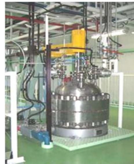
福島第二工場 500L高圧反応装置
